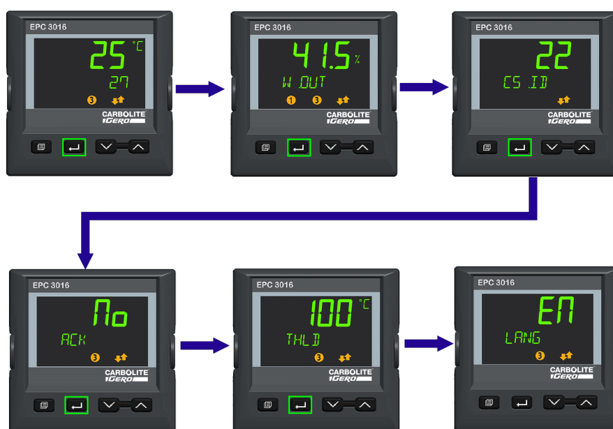
Défilement des paramètres du régulateur au niveau Opérateur 2.
