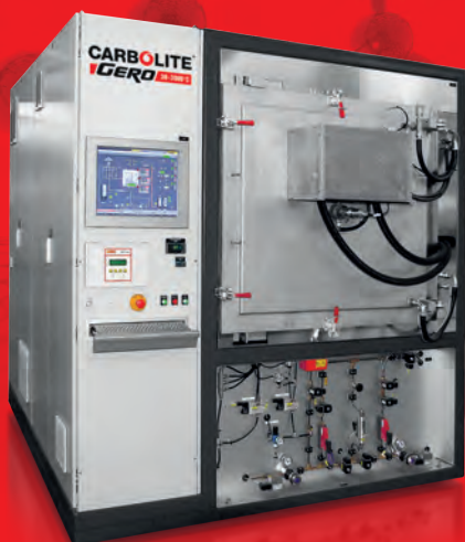
Камерная печь НТК 400 GR/22 (максимальная рабочая температура 2200 °C) с полностью автоматическим управлением от ПЛК
