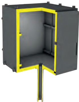
Рис. 8: Схема реторты печи НТК с газовыпускным отверстием в нижней части
