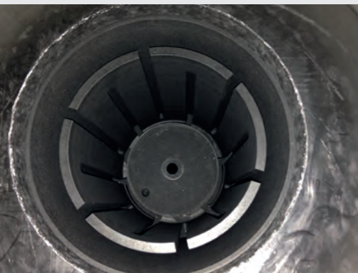
Рис. 15: Кольцевой нагревательный элемент (вид сверху) печи LHTG, в центре пода печи расположено газовыпускное отверстие
