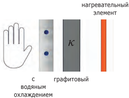
Рис. 13: Схема зоны нагрева печи с нагревательными элементами и теплоизоляцией из графита (реторта с водяным охлаждением)
