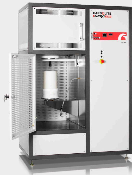
Piec BLF 18/8 z odwróconym tygłem, przepływomierzem do gazu oraz przesłoną do promieniowania jako opcją.
