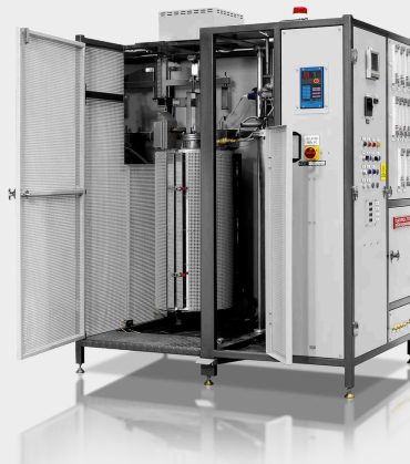
IOR - Cuptor de Reductibilitate pentru Minereu de Fier
