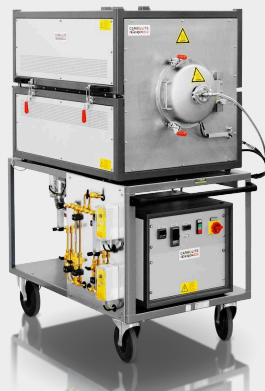
GLO 10 / 11-1G: Cuptor compact cu perete fierbinte cu retort din oțel inoxidabil și retort opțional inconel (vidare până la 750°C și la presiune normală până la 1100°C)
