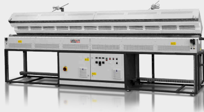
Zákazková trojzónová pec FZS 13/ 100/4500 s vykurovacou dĺžkou 4500 mm, s automatickým otváraním a pracovnou rúrkou APM
