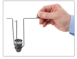
Standard drótos tégelytartó (képen fedeles tégellyel együtt) (VFM/ASTM) - kemence alapkiépítéséhez tartozik
