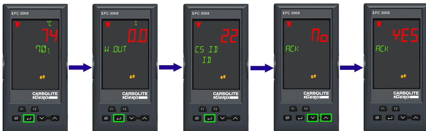
Подтверждение сигнала тревоги
