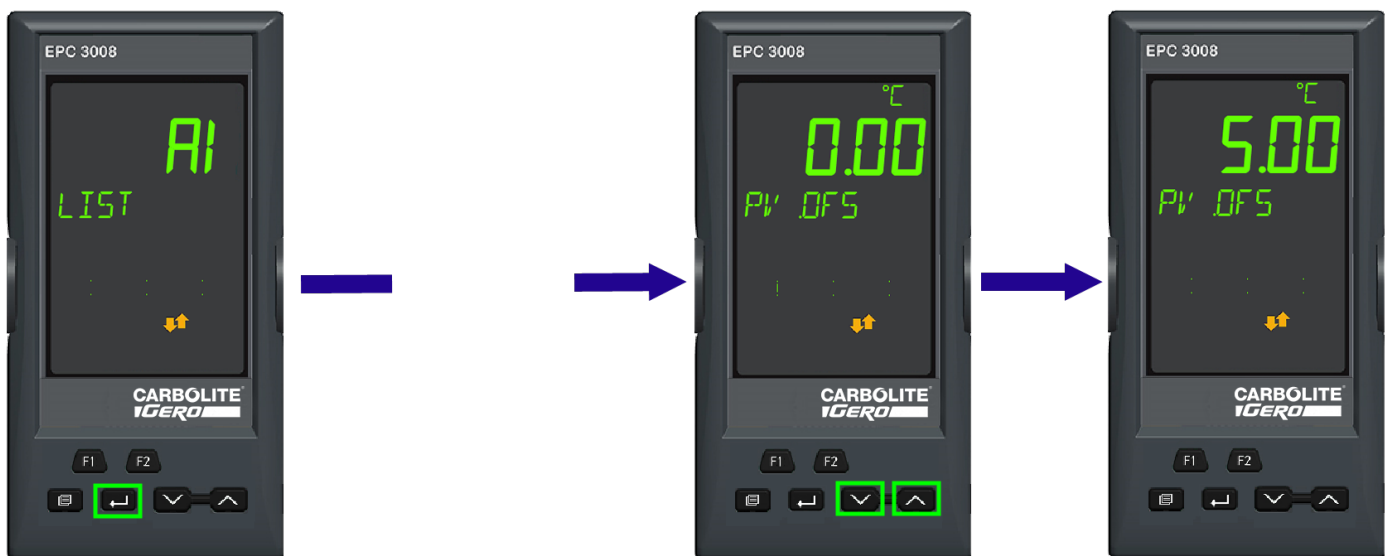
Regolazione del valore di offset
