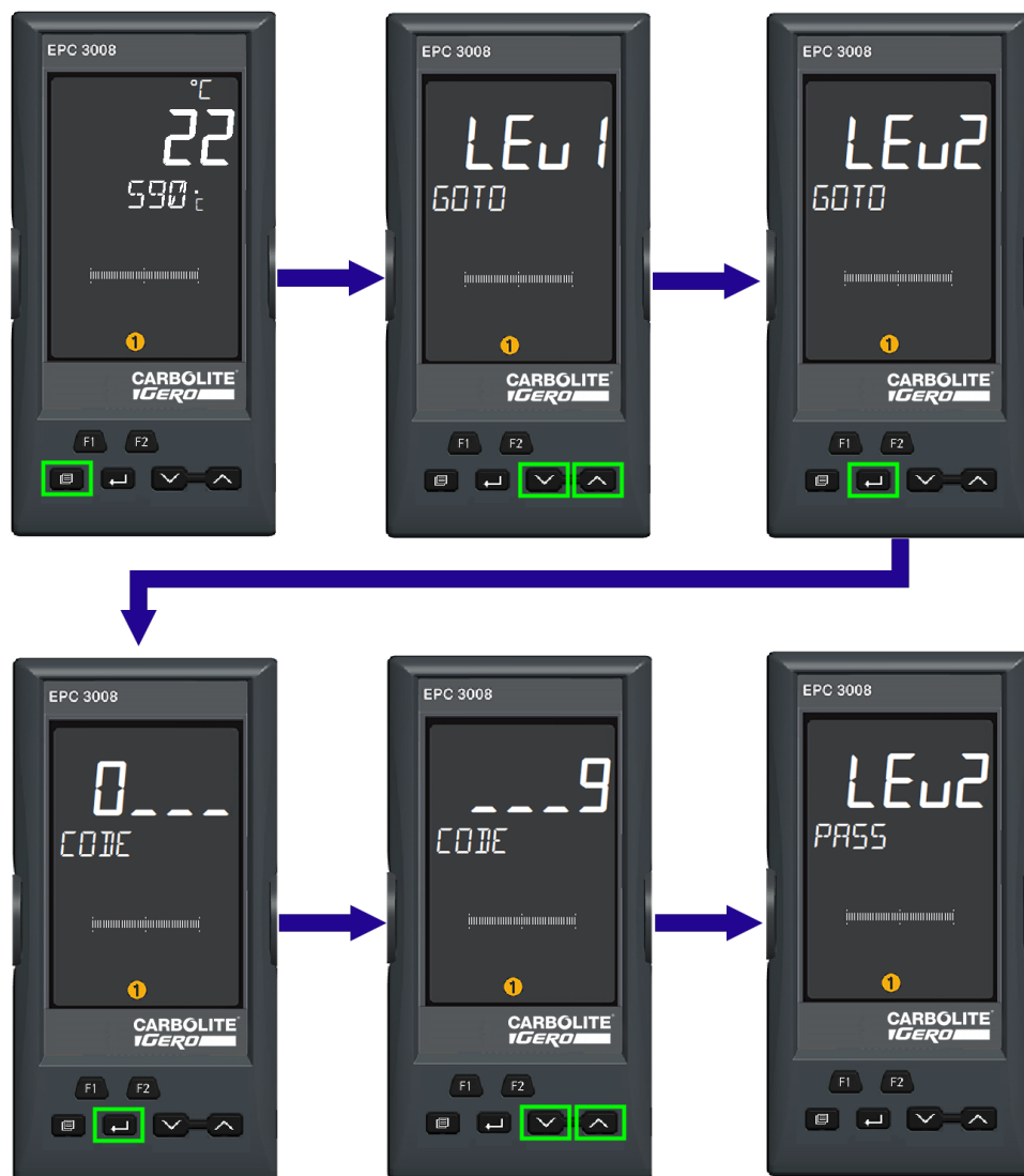
Passaggio al Livello 2 operatore
