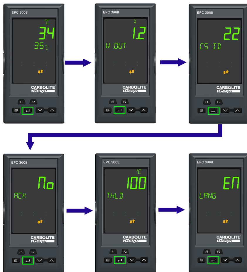
Scorrimento nelle impostazioni del controllore al Livello 2 operatore
